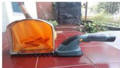
Gambar 4. Mesin Petik Teh Tipe Baterai E-Tem M01 7,2 Volt 3000 mAh Collection Bag dan E-Tem M01 7,2 Volt 3000 mAh Collection Bag
