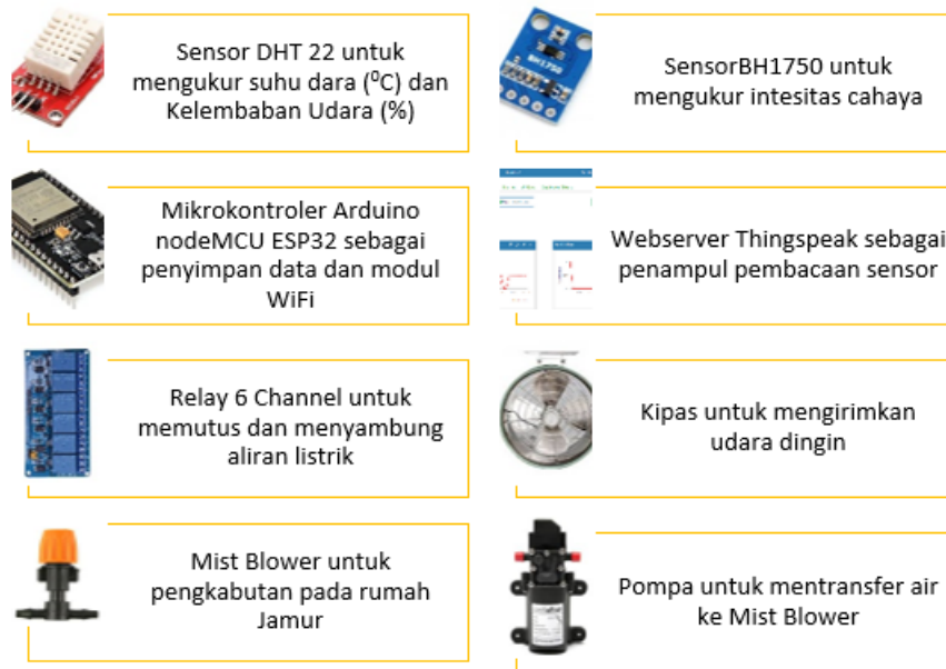
Gambar 3. Komponen Monitoring Rumah Jamur
